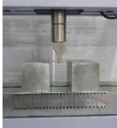
Gambar 3: Uji Kekuatan Transversa akrilik Gambar 4: Uji Kekuatan Transversa nilon termoplastik
