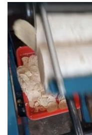
Gambar 3. Pengirisan tempe menggunakan mesin
